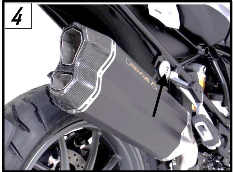
Montieren Sie die REMUS Hitzeschutzabdeckung mit den serienmäßigen Schrauben. Zur Positionierung der Hitzeschutzabdeckung drehen Sie die am Schalldämpfer montierte Schelle in die gewünschte Richtung. Der Abstand zwischen Hitzeschutz und Klappengehäuseabdeckung sollte gleichmäßig sein. Positionieren Sie den Schalldämpfer und ziehen alle Schrauben fest (Abb. 5 / 6).
