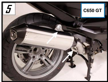
Montieren Sie den REMUS Schalldämpfer am Verbindungsrohr. Hängen Sie die beiden Federn ein, positionieren Sie den Schalldämpfer und ziehen alle Schrauben fest (Abb. 5 / 6). Achtung, verwenden Sie die mitgelieferte Distanzbuchse zwischen den Halterungen (Abb. 7)
