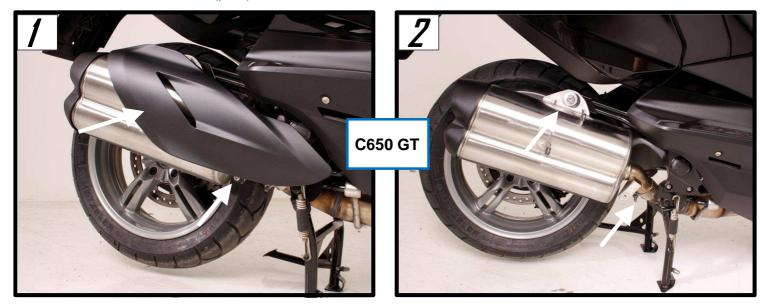
Lösen Sie die Halterschraube und die Schelle des Serienschalldämpfers und nehmen diesen ab(Abb. 2 / 3). Loosen the bracket screw and the clamp of the serial muffler and remove it (pic.2 / 3).
