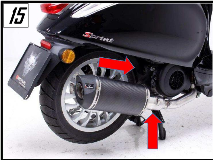
Befestigen Sie den Schalldämpfer mittels der mitgelieferten
