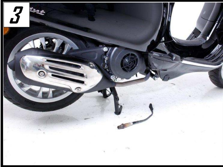
Entfernen Sie die Befestigungsmuttern des Krümmers. (Abb.4)
