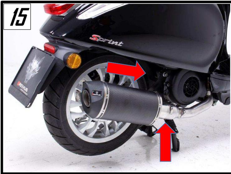
Befestigen Sie den Schalldämpfer mittels der mitgelieferten
