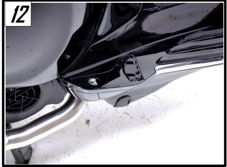
Schrauben Sie die Lambdasonde wieder fest, und schließen Sie diese wieder am dafür vorgesehenen Anschluss an, Montieren sie wieder die Abdeckung. (Abb.14/2/11)
