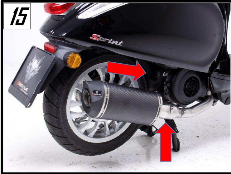
Befestigen Sie den Schalldämpfer mittels der mitgelieferten
