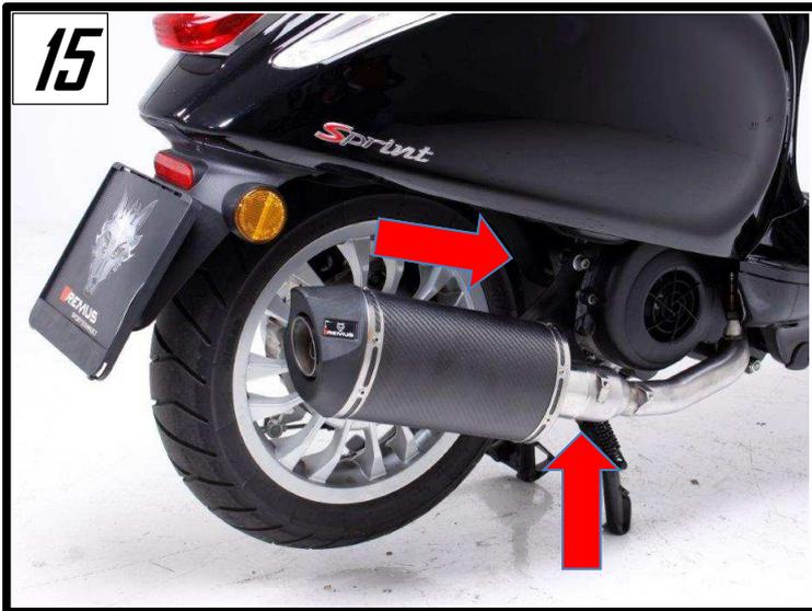
Befestigen Sie den Schalldämpfer mittels der mitgelieferten
