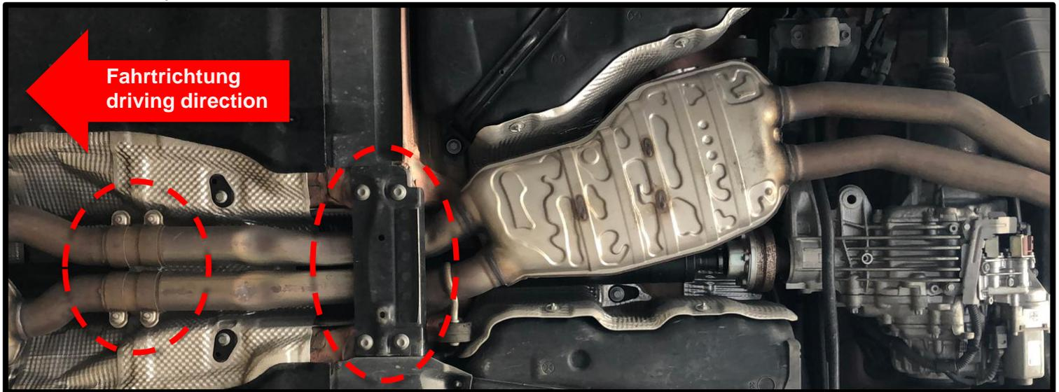
Die Aktuatoren abschließen, die Aufhängungsgummis aushängen und den serienmäßigen Endschalldämpfer abnehmen.
