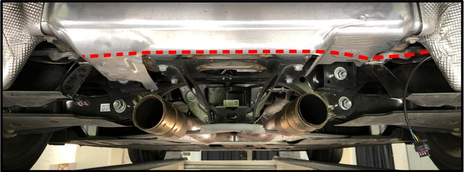
Den REMUS Sportschalldämpfer mit Hilfe der Auspuffschellen an den Serienrohren montieren und die Gummiaufhängungen an den Befestigungspunkten der Karosserie einhängen. Die Aktuatoren mit dem REMUS Y-Kabel anschließen.
