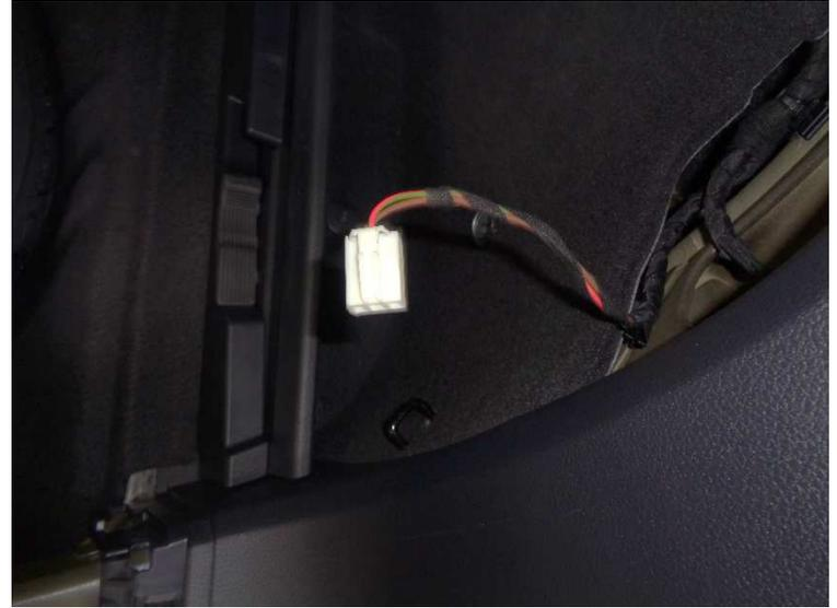
Lockern sie die Seitenverkleidung des Kofferraums und verlegen sie das REMUS Zuleitungskabels hinter dieser Verkleidung zum 12V Stecker.
