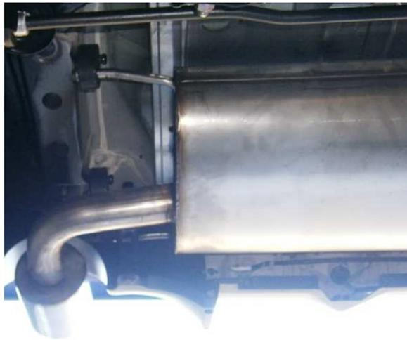
Klemm- oder Schraubverbindungen locker vorziehen. Den REMUS Sportschalldämpfer ausrichten und die Verbindungen fest anziehen. Motor kurz anlassen und den kompletten REMUS Sportschalldämpfer auf Dichtheit überprüfen. Sämtliche Bauteile, sowohl im kalten als auch im betriebswarmen Zustand auf Funktion und genügend Freigängigkeit überprüfen. Achten Sie dabei auf einen ausreichend belüfteten Montageaum.
