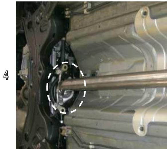
Den REMUS Sportschalldämpfer am Flansch des Racingrohrs montieren und die Gummiaufhängungen an den Befestigungspunkten der Karosserie einhängen. (Abb. 5-6)
