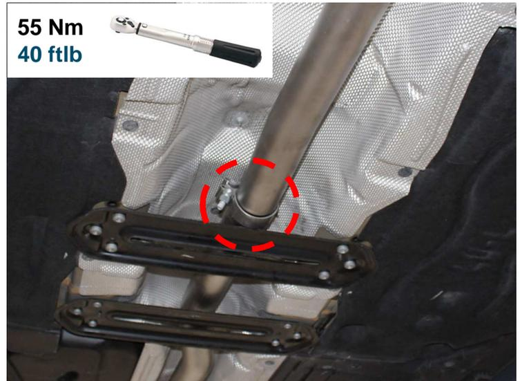
**ACHTUNG:** Bei Montage auf einen 5-Türigen Mini Cooper S F55 muss der Längenausgleichsadapter, beige packt beim REMUS Sportschalldämpfer, zwischen dem REMUS Vorschalldämpferersatzrohr und dem REMUS Verbindungsrohr montiert werden!
