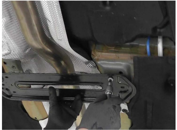
Klemm- oder Schraubverbindungen locker vorziehen. Den REMUS Sportschalldämpfer ausrichten und die Verbindungen fest anziehen. Motor kurz anlassen und den kompletten REMUS Sportschalldämpfer auf Dichtheit überprüfen. Sämtliche Bauteile, sowohl im kalten als auch im betriebswarmen Zustand auf Funktion und genügend Freigängigkeit überprüfen. Achten Sie dabei auf einen ausreichend belüfteten Montagebereich.
