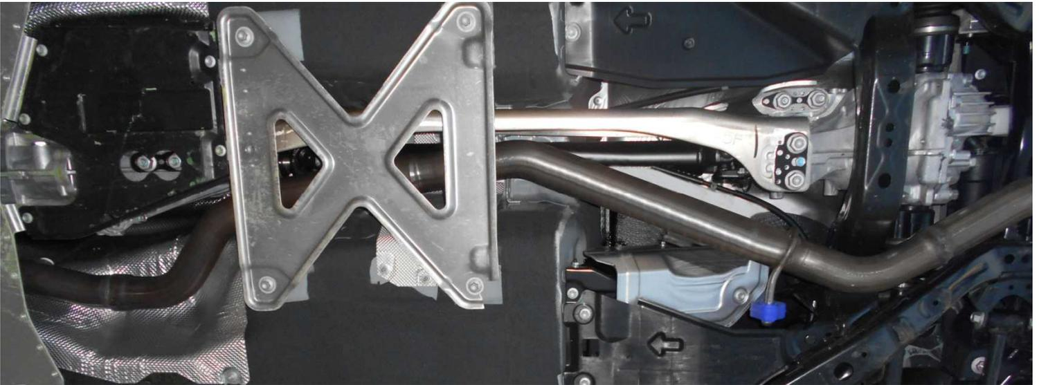
Den REMUS Sportschalldämpfer am Vorschalldämpfer montieren. Das entfernte Fahrzeugblech wieder montieren.
