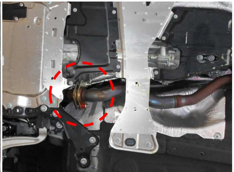
Die Flanschverbindung zwischen Endschalldämpfer und Vorschalldämpfer lösen, den Aufhängungsgummi aushängen und den serienmäßigen Vorschalldämpfer abnehmen.
