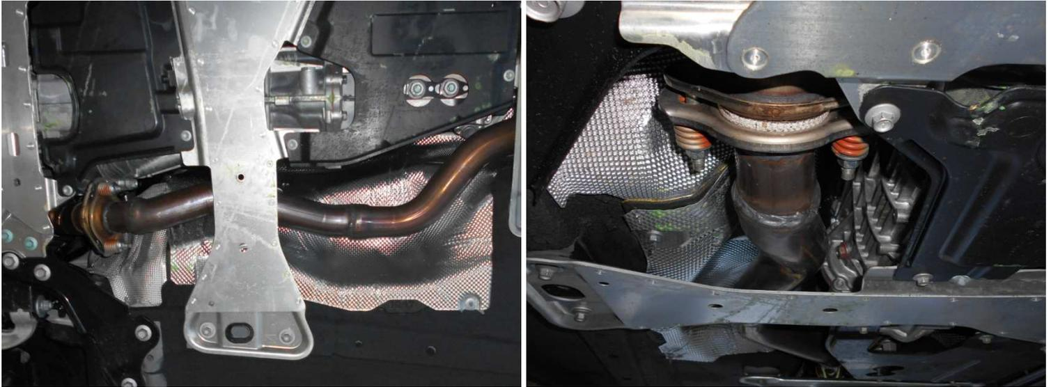
Das REMUS Vorschalldämpferersatzrohr am REMUS Flanschverbindungsrohr montieren und die Gummiaufhängung an dem Befestigungspunkt der Karosserie einhängen.
