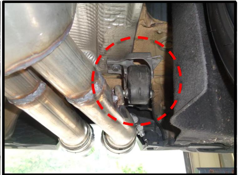
Die REMUS Endrohre am REMUS Sportschalldämpfer montieren und ausrichten.
