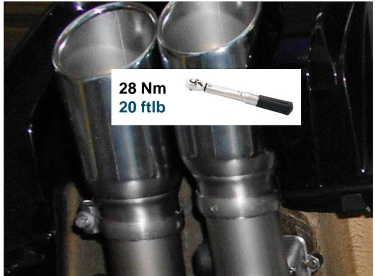
Klemm- oder Schraubverbindungen locker vorziehen. Die REMUS Abgasanlage ausrichten und die Verbindungen fest anziehen. Motor kurz anlassen und die komplette REMUS Abgasanlage auf Dichtheit überprüfen. Sämtliche Bauteile, sowohl im kalten als auch im betriebswarmen Zustand auf Funktion und genügend Freigängigkeit überprüfen. Achten Sie dabei auf einen ausreichend belüfteten Montagebereich.
