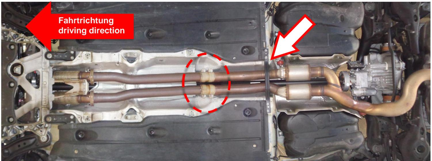
Die Aufhängungsgummis aushängen, die Aktuatoren abschließen und die serienmäßige Abgasanlage abnehmen.
