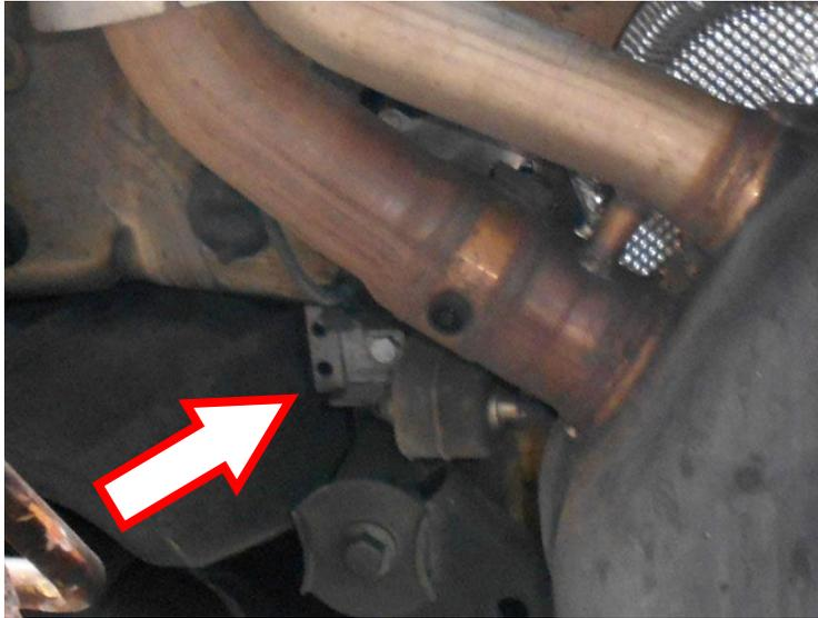
Den REMUS Vorschalldämpfer auf das serienmäßige Rohr aufschieben. Das REMUS Verbindungsrohr am REMUS Vorschalldämpfer montieren. Die Gummiaufhängungen an den Befestigungspunkten der Karosserie einhängen. Die Querstrebe wieder montieren.
