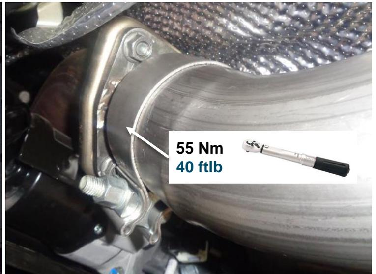
Das REMUS Mittelschalldämpferersatzrohr auf das Vorschalldämpferersatzrohr aufschieben. Die Schraubverbindungen locker anziehen um das Abgassystem noch ausrichten zu können.
