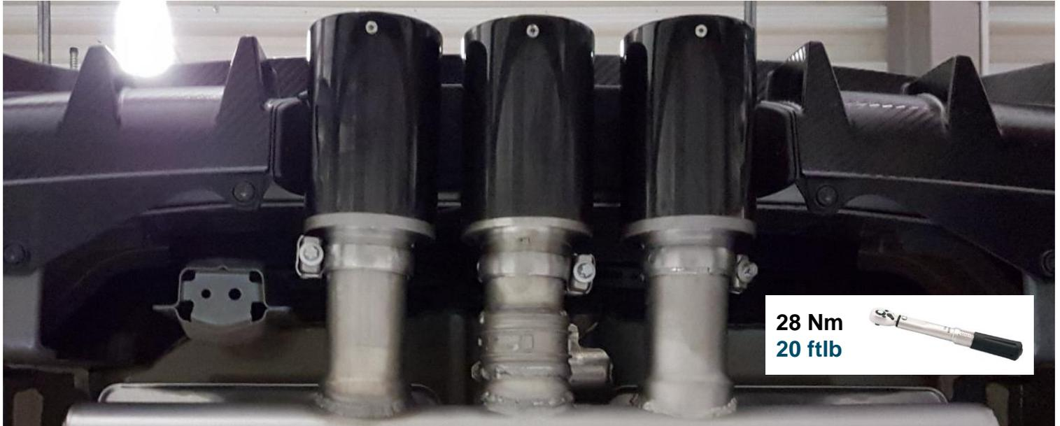
Klemm- oder Schraubverbindungen locker vorziehen. Die REMUS Abgasanlage ausrichten und die Verbindungen fest anziehen. Motor kurz anlassen und die komplette REMUS Anlage auf Dichtheit überprüfen. Sämtliche Bauteile, sowohl im kalten als auch im betriebswarmen Zustand auf Funktion und genügend Freigängigkeit überprüfen. Achten Sie dabei auf einen ausreichend belüfteten Montagebereich.
