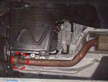
Die Aufhängungsgummis aushängen, den Aktuator abschließen und die serienmäßigen Abgasanlage abnehmen. Unplug the actuator cable and remove the standard exhaust system with the rubber supports.
