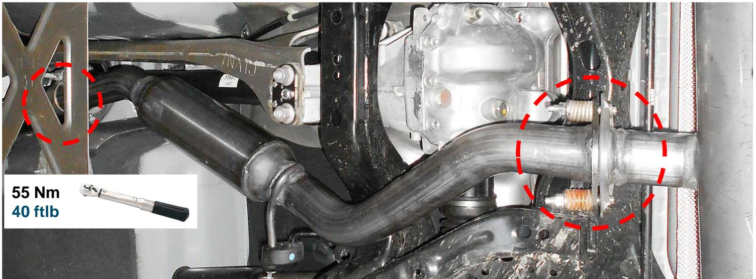
Klemm- oder Schraubverbindungen locker vorziehen. Den REMUS Vorschalldämpfer ausrichten und die Verbindungen fest anziehen. Motor kurz anlassen und den komplette REMUS Abgasanlage auf Dichtheit überprüfen. Sämtliche Bauteile, sowohl im kalten als auch im betriebswarmen Zustand auf Funktion und genügend Freigängigkeit überprüfen. Achten Sie dabei auf einen ausreichend belüfteten Montageaum.
