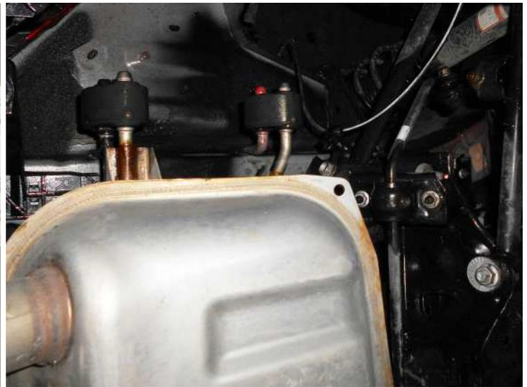
Die Aufhängungsgummis am Sportschalldämpfer montieren. Die Heckschürze laut beiliegender Ausschnittschablone nachschneiden.
