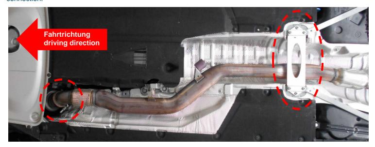
Den Aktuator abschließen, die Aufhängungsgummis aushängen und den serienmäßigen Endschalldämpfer abnehmen. Den Serienaktuator und das Hitzeschutzblech vom Serienendschalldämpfer demontieren. Disconnect the actuator and remove the standard exhaust system with the rubber supports. Remove the standard actuator and the heat shield from the standard rear silencer.
