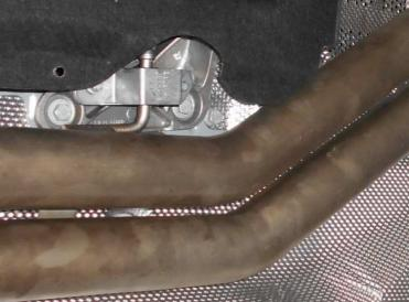
Die mitgelieferten Zusatzhalter am Fahrzeugboden montieren. Das linke und rechte REMUS Verbindungsrohr am REMUS Flanschrohr montieren und mit Hilfe der mitgelieferten Gummiaufhängungen an den montierten Haltern einhängen.
