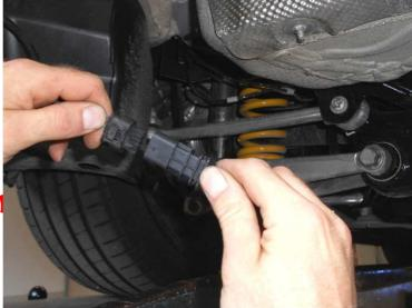
Das Y-Kabel unter dem Hitzeschutzblech und über dem Haltern verlegen.
