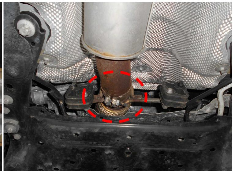
Die Querstreben demontieren. Die Aufhängungsgummis aushängen und die serienmäßige Abgasanlage abnehmen.
