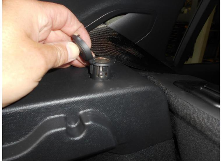
Den roten Draht des REMUS Zuleitungskabels hinter der Verkleidung zur 12V Steckdose verlegen.
