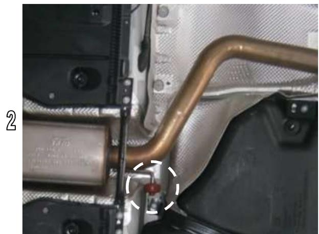
Den REMUS Vorschalldämpfer auf das serienmäßige Rohr aufschieben und die Gummiaufhängung an dem Befestigungspunkt der Karosserie einhängen. (Abb. 4)
