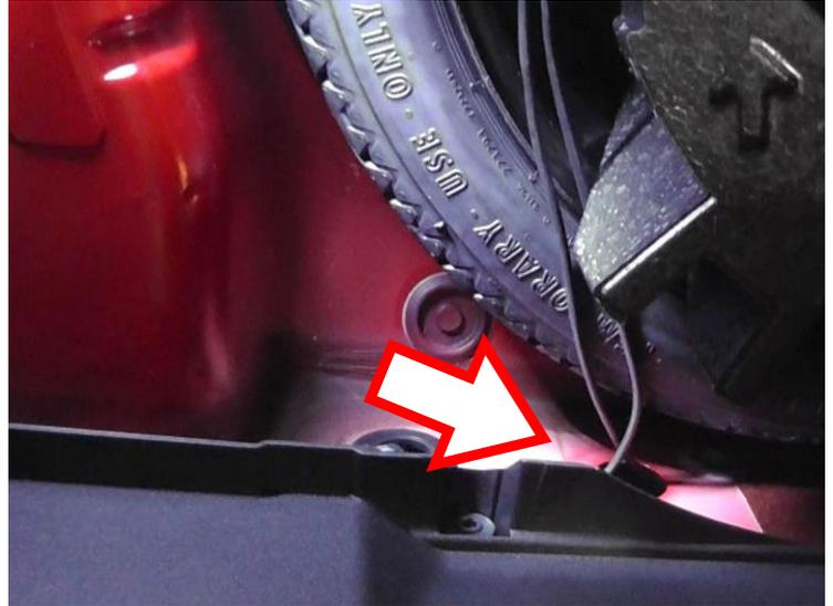
Die Gummiabdeckung für die Kabel einschneiden und den Gummi wieder montieren.
