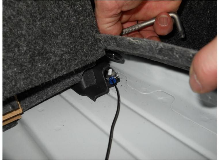
Das rote Kabel des Zuleitungskabels vom unteren Ende bis zur Kofferraumleuchte der Verkleidung verlegen. Das rote Kabel (+) des Zuleitungskabels mit Hilfe des mitgelieferten Schwachstromverbinders am blau/roten Kabel der Kofferraumleuchte installieren.
