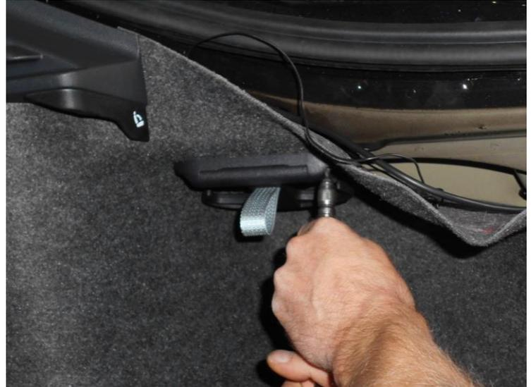
Die Aktuorkabel und das Zuleitungskabel mit der REMUS Steuereinheit verbinden. Die Steuereinheit im mit Hilfe der mitgelieferten Kabelbinder und des Klebesockels im Kofferraum verstauen. Die entfernten Abdeckungen und demontierten Teile wieder montieren. Die Aktuorkabel mit dem linken und rechten Aktuator des REMUS Sportschalldämpfers verbinden.
