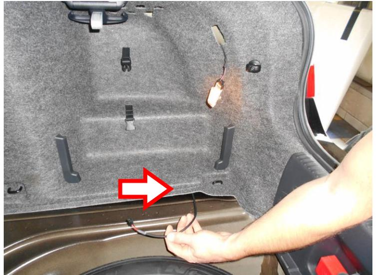
Das rote Kabel (+) des Zuleitungskabels mit Hilfe des mitgelieferten Schwachstromverbinders am blau/roten Kabel der Kofferraumleuchte installieren.
