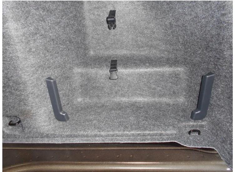
Die rechte Kofferraumleuchte vorsichtig heraus ziehen um zum Hohlraum dahinter zu gelangen. Den Dichtungsgummi auf der rechten Fahrzeugseite ablösen.
