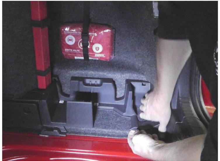
Die Schraube lösen um die Seitenverkleidung zu lockern. Das rechte Kofferraumleuchte vorsichtig heraus ziehen um zum Hohlraum dahinter zu gelangen.
