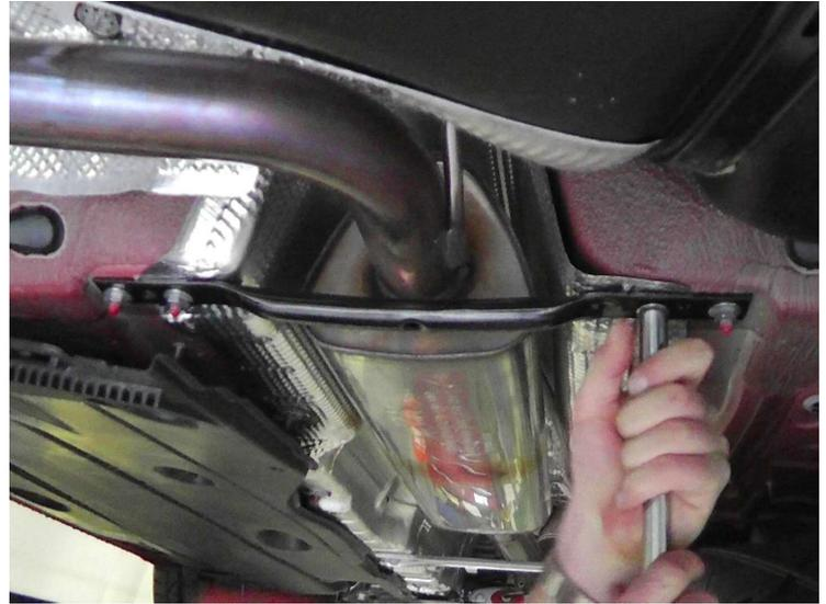
Die Schellenverbindung zwischen Vorschalldämpfer und Katalysator lösen. Die Aufhängungsgummis aushängen und die serienmäßige Abgasanlage abnehmen.
