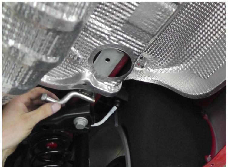
Den REMUS Vorschalldämpfer auf das serienmäßige Rohr aufschieben. Das REMUS Verbindungsrohr am REMUS Vorschalldämpfer montieren. Die Gummiaufhängungen an den Befestigungspunkten der Karosserie einhängen.
