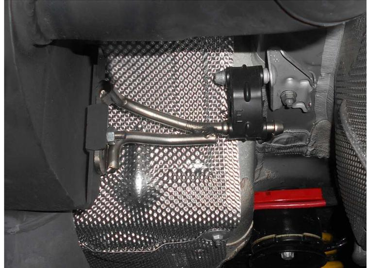
Den REMUS Sportschalldämpfer am Serienrohr montieren und die Gummiaufhängungen an den Befestigungspunkten der Karosserie einhängen. Die REMUS Endrohrbögen am REMUS Sportschalldämpfer montieren. Den Aktuator der serienmäßigen Klappensteuerung an der dafür vorgesehenen Halterung am Sportschalldämpfer montieren und das Aktuorkabel anschließen.
