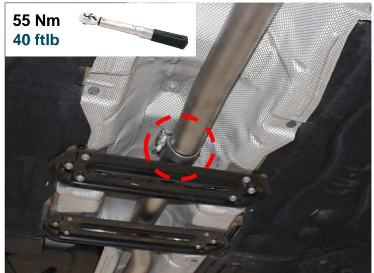
Den REMUS Sportschalldämpfer am REMUS Verbindungsrohr montieren und die Gummiaufhängungen an den Befestigungspunkten der Karosserie einhängen.
