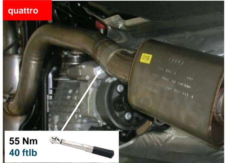
Den REMUS Sportschalldämpfer am Verbindungsrohr montieren und die Gummiaufhängungen an den Befestigungspunkten der Karosserie einhängen. Die REMUS Endrohrbögen auf den REMUS Sportschalldämpfer aufschieben. Den Aktuator vom Serienendschalldämpfer abnehmen, am REMUS Sportschalldämpfer montieren und anschließen. Der Aktuator justiert sich während der ersten Fahrt automatisch.
