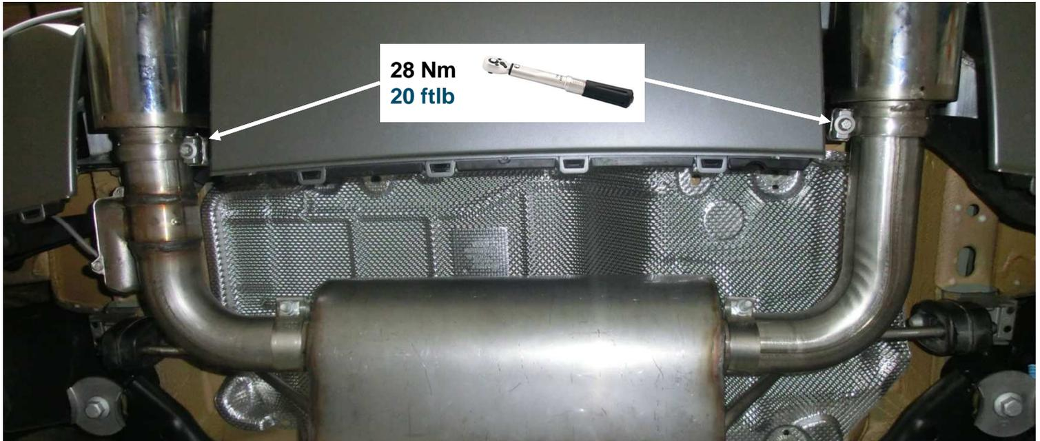
Klemm- oder Schraubverbindungen locker vorziehen. Den REMUS Sportschalldämpfer ausrichten und die Verbindungen fest anziehen. Motor kurz anlassen und den kompletten REMUS Sportschalldämpfer auf Dichtheit überprüfen. Sämtliche Bauteile, sowohl im kalten als auch im betriebswarmen Zustand auf Funktion und genügend Freigängigkeit überprüfen. Achten Sie dabei auf einen ausreichend belüfteten Montagebereich.
