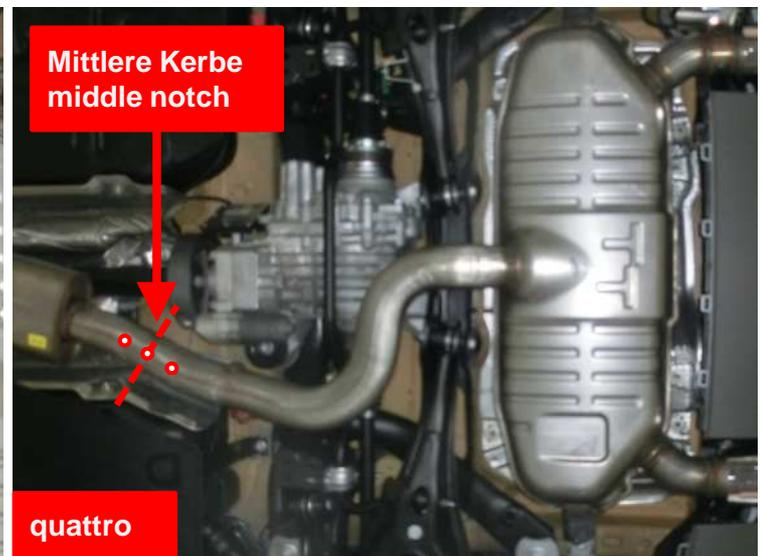
Den Aktuator abschließen, die Aufhängungsgummis aushängen und den serienmäßigen Endschalldämpfer abnehmen.
