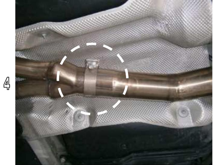
Den Serienendschalldämpfer auf den REMUS Vorschalldämpfer aufschieben. Alternativ den REMUS Sportschalldämpfer montieren. Bei Montage des Serienschalldämpfers muss die Anlage beschnitten werden.
