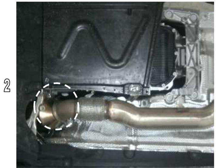
Die Aufhängungsgummis aushängen und den serienmäßigen Vorschalldämpfer abnehmen. Die Aufhängungsgummis am Verbindungsrohr montieren.
