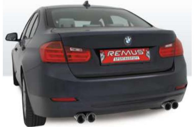
Klemm- oder Schraubverbindungen locker vorziehen. Den REMUS Sportschalldämpfer ausrichten und die Verbindungen fest anziehen. Motor kurz anlassen und den kompletten REMUS Sportschalldämpfer auf Dichtheit überprüfen. Sämtliche Bauteile, sowohl im kalten als auch im betriebswarmen Zustand auf Funktion und genügend Freigängigkeit überprüfen. Achten Sie dabei auf einen ausreichend belüfteten Montageaum.
