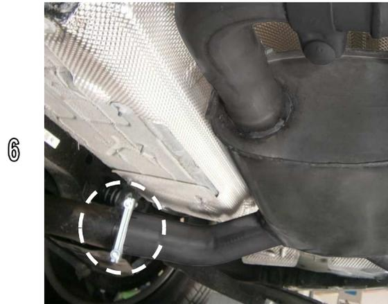
Den REMUS Sportschalldämpfer auf das durchtrennte serienmäßige Rohr aufschieben und die Gummiaufhängungen an den Befestigungspunkten der Karosserie einhängen. (Abb. 6-7)
