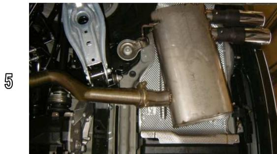
Klemm- oder Schraubverbindungen locker vorziehen. Den REMUS Sportschalldämpfer ausrichten und die Verbindungen fest anziehen. Motor kurz anlassen und den kompletten REMUS Sportschalldämpfer auf Dichtheit überprüfen. Sämtliche Bauteile, sowohl im kalten als auch im betriebswarmen Zustand auf Funktion und genügend Freigängigkeit überprüfen. Achten Sie dabei auf einen ausreichend belüfteten Montageaum.
