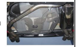
☐ Motor kurz anlassen und den kompletten Sportschalldämpfer auf Dichtheit überprüfen.
