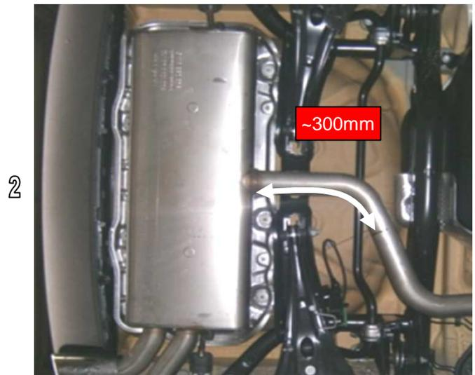
**Schnittmaß = mittlere Kerbe oder ~300mm ab Schweißnaht (An der Rohrrinnenseite messen.)**
