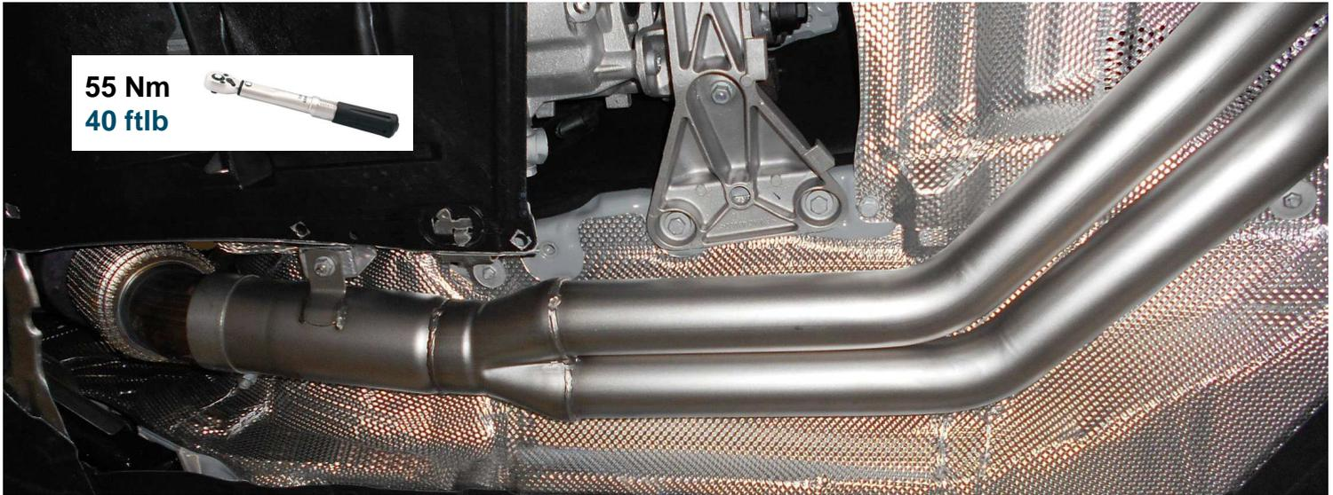
Das REMUS Vorschalldämpferersatzrohr am Verbindungsrohr montieren und die Gummiaufhängungen an den Befestigungspunkten der Karosserie einhängen.
