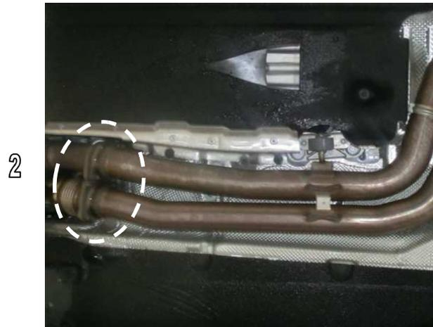
Die Aufhängungsgummis aushängen, die Aktuatoren des Endschalldämpfers abschließen und die serienmäßige Abgasanlage abnehmen. (Abb.3) Die Aufhängungsgummis am REMUS Sportschalldämpfer montieren.
