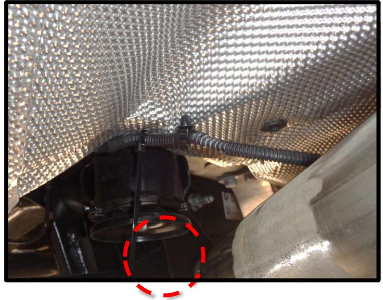
Die REMUS Endrohre am REMUS Sportschalldämpfer montieren und ausrichten. Alle entfernten Streben und Verkleidungen wieder anbringen.
