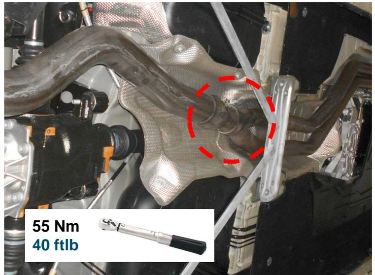
Die Aufhängungsgummis am REMUS Sportschalldämpfer montieren. Den REMUS Sportschalldämpfer am REMUS Vorschalldämpfer / Ersatzrohr montieren und die Gummiaufhängungen an den Befestigungspunkten der Karosserie einhängen.
